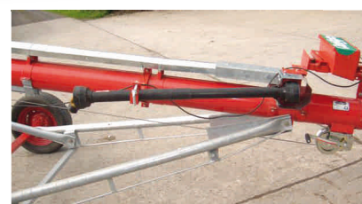
pohon vývodovým hřídelem
