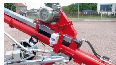
kombinovaný pohon elektromotor x hydromotor
